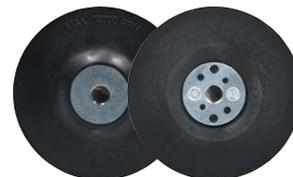
**Tipo con foro filettato M14 e scanalature** che favoriscono la dispersione del calore e un contatto più aggressivo con la superficie - Adatto per lavorazioni con pressioni forti sul disco, per utilizzo di grane grosse e per ridurre lo sviluppo del calore durante l'abrasione - Esecuzione molto dura
